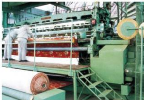
电脑阿克斯明斯特编织提花地毯织机 Axminster loom with an electronic jacquard
